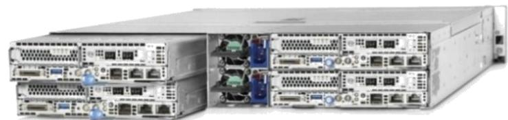
基于Intel®最新一代Purley平台设计，使用Lewisbug芯片组。标准2U2路机架服务器。
